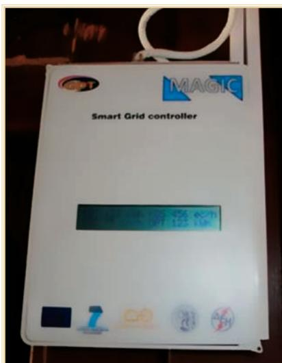
Fig. 4 – O controlador de cargas inteligente usado pelo sistema Magic no teste de campo C
